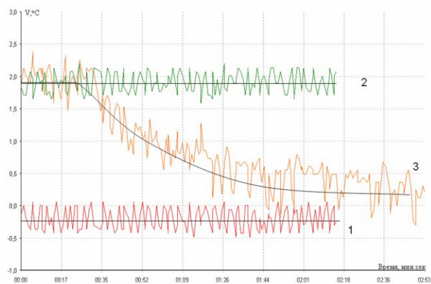
Рис.6.19. Осциллограммы сигналов. 1- сигнал, содержащий только шум; 2- содержащий шум при r = 1.3 ; 3- при включенном управлении, k_n = 2.5, r = 1.3 .
