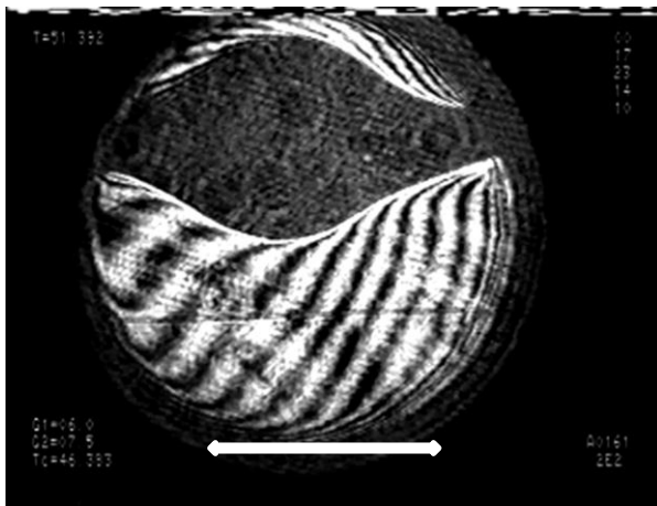
Рис. 4.18. Область оптической неоднородности через 23 с после теплового импульса при T - T_c = 5 К
