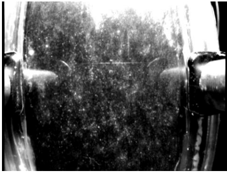
Рис. 2.32. Изображение хаотического режима, возникшего при разрушении изогнутых горизонтальных конвективных валов, область "E", Ra_g = 7.9 \cdot 10^4 , Ra_v = 7.4 \cdot 10^3
