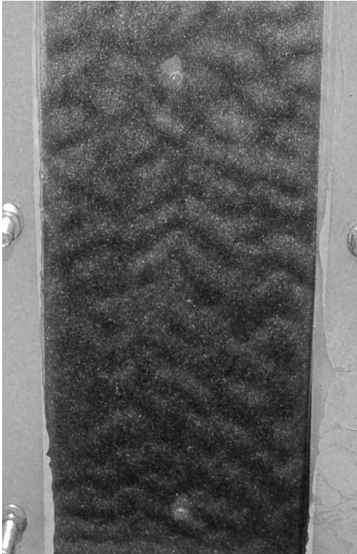
Рис. 2.19. Трехмерный нестационарный режим конвекции в вертикальном слое жидкости Ra_g = 6.4 \cdot 10^4 , Ra_v = 1.3 \cdot 10^3 ; область параметров "С", термограмма и ее спектр
