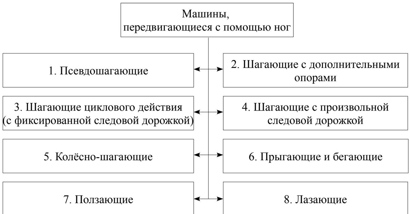
Рисунок 1.1 — Классификация машин, передвигающихся с помощью ног
