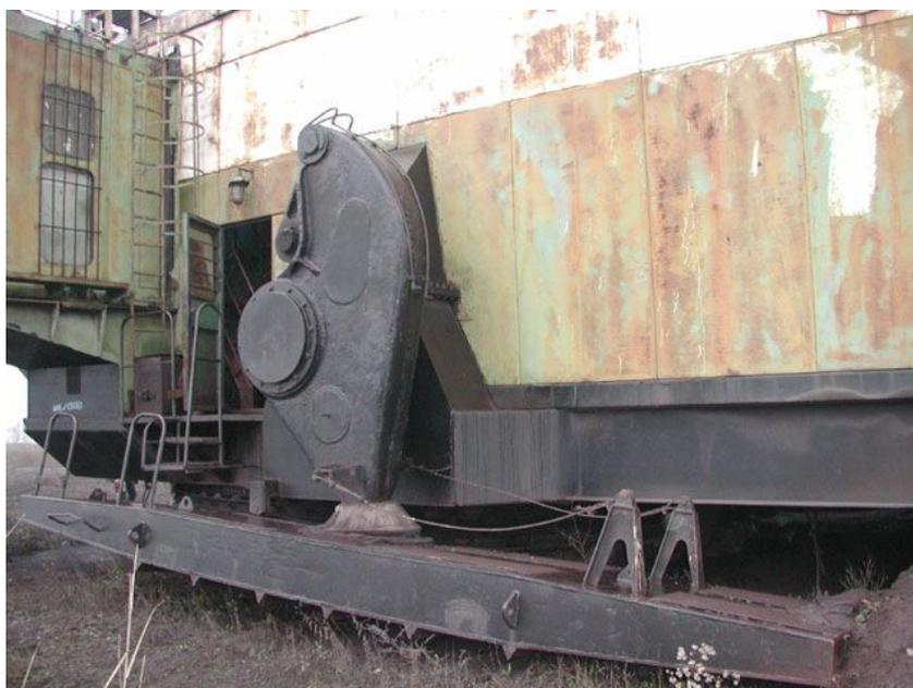
Рисунок 1.20 — Механизм шагания экскаватора ЭШ6/45
