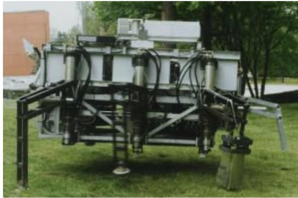
Рисунок 1.56 — Шагающая машина MECANT, Финляндия
