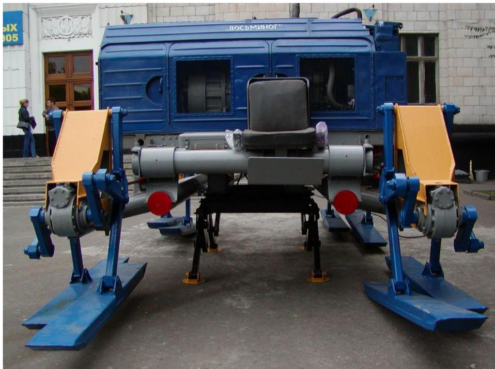
Рисунок 1.60 — Машина «Восьминог М» с движителями различных типов
