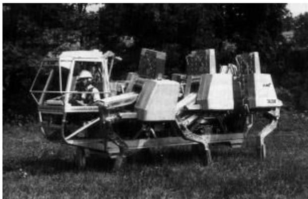
Рисунок 1.46 — Шагающая машина ASV, США
