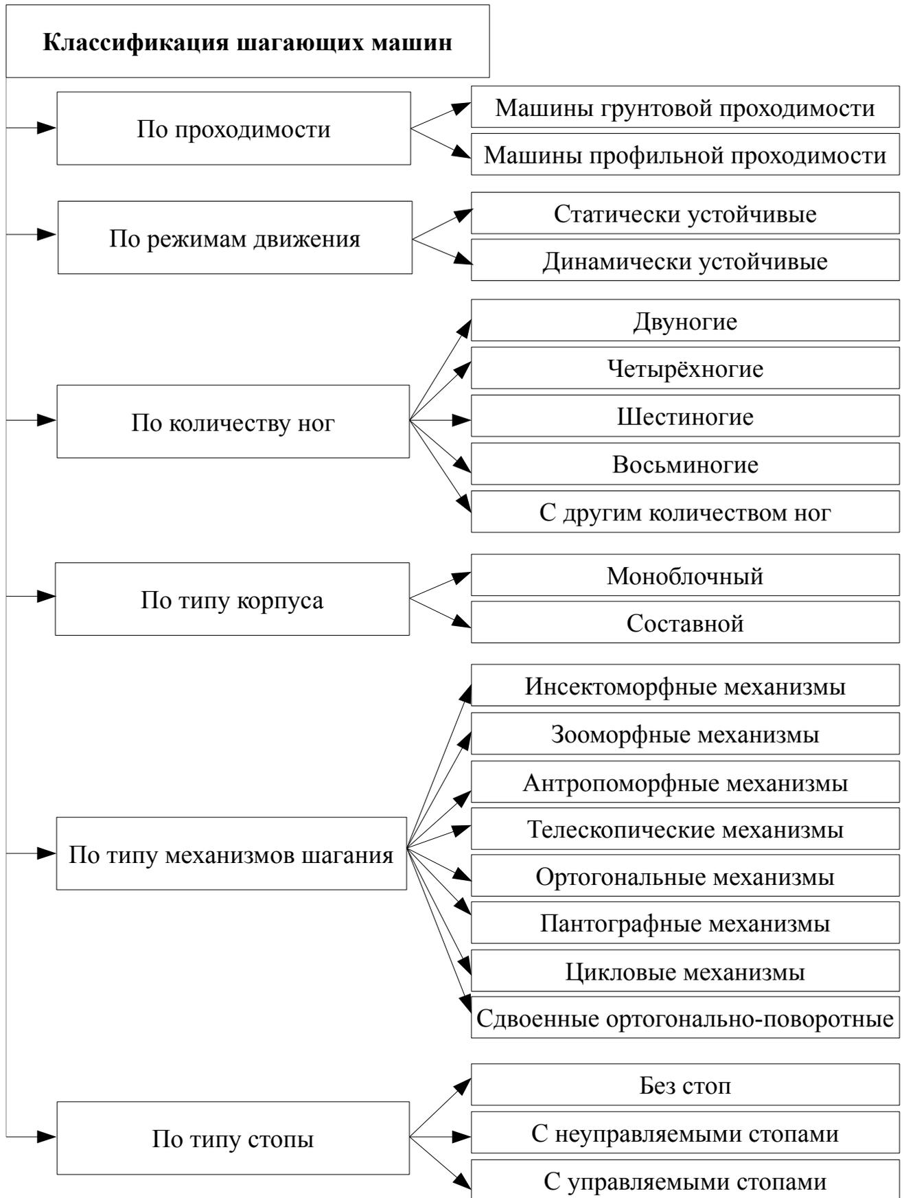
Рисунок 1.26 — Схема классификации шагающих машин
