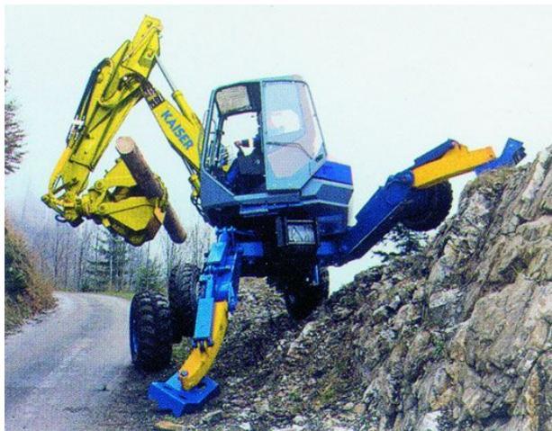
Рисунок 1.14 — Колёсно-шагающий экскаватор Kaiser (Германия)
