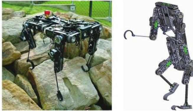
Рисунок 1.24 — Лазающий робот LitleAre с крючковыми захватами (Германия)
