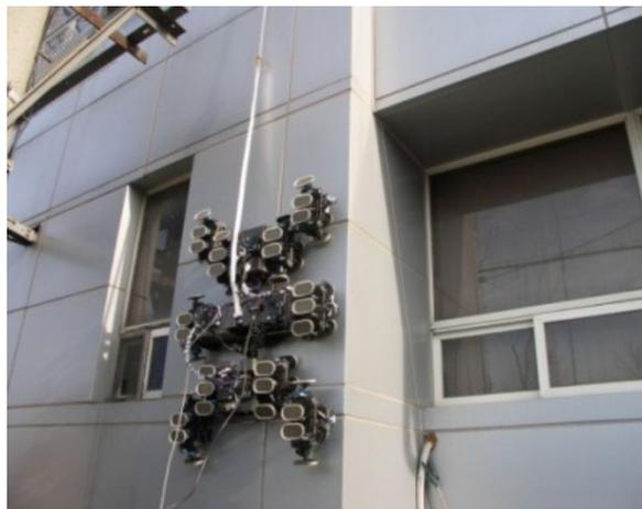
Рисунок 1.27 — Лазающий робот с составным корпусом. Корея
