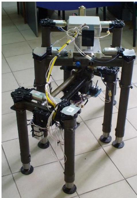
Рисунок 1.54 — Робот с ортогональным движителем, ВолгГТУ, Волгоград, РФ
