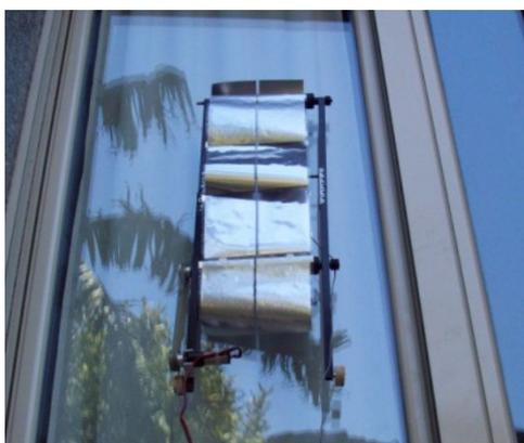
Рисунок 1.21 — Лазающий робот с электростатическим сцеплением (Италия)
