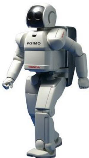
Рисунок 1.49 — Антропоморфный шагающий робот «ASIMO» (Япония).
