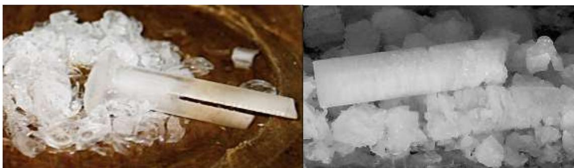
Рис. 4.16. Слева: обтекание льдом препятствия со скоростями от 300 м/год до первых десятков километров в час, справа: истечение льда при наличии тонкой водяной пленки и регулируемой скорости истечения льда
