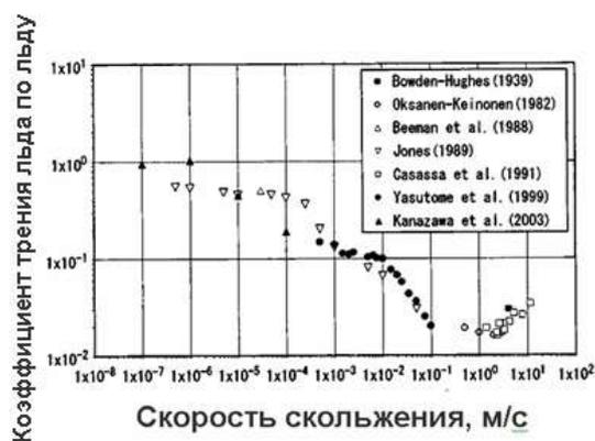
Рисунок 1.23. Обобщенная зависимость коэффициентов трения льда по льду от скорости скольжения при температуре  $-10^{\circ}$  С [Maeno et al. (2004)]
